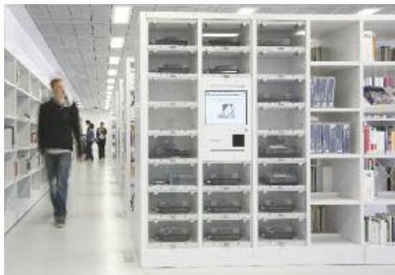
In der Stadtbibliothek Stuttgart sorgt die RFID-basierte Schließfachlösung EasyShelfSolution für die Selbstausleihe von mobilen Geräten.
